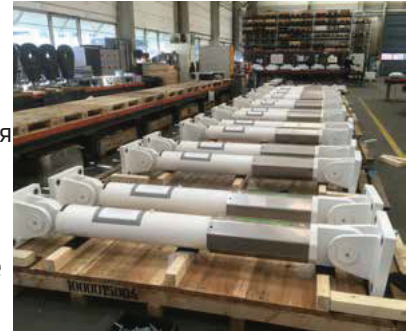
Гидравлические демпферы в собранном виде
